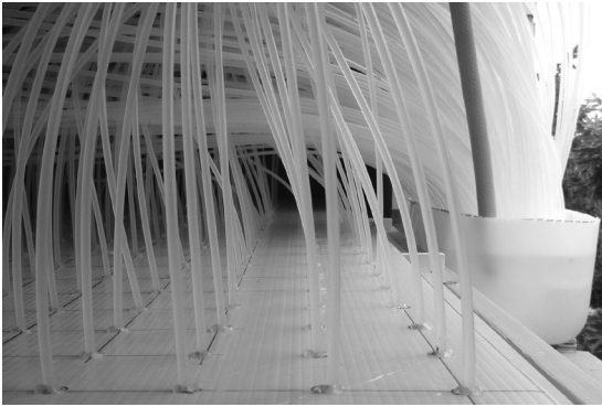
図5 09型の滴下部を上側から眺めた様子
