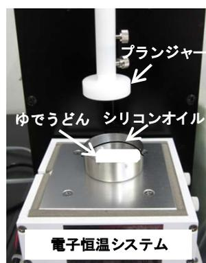
図 1. 圧縮によるクリープ測定モデル化
