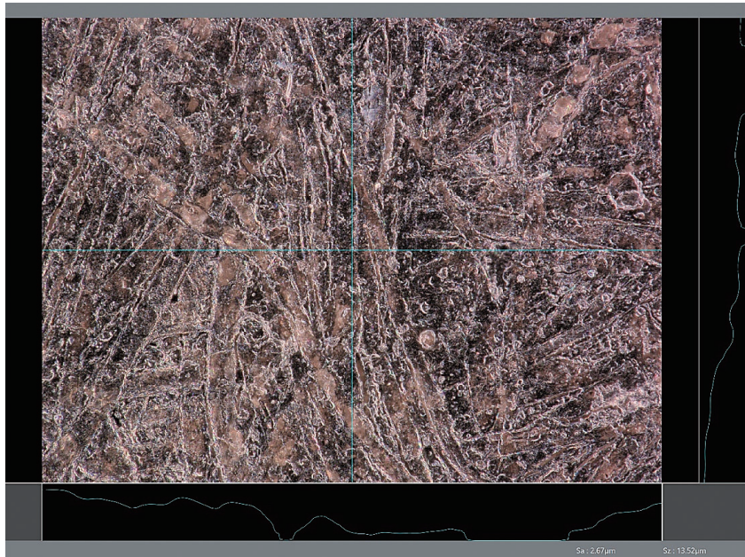
【図4 第1紙表面の全領域の粗さ観察画像(墨部、x500)】
